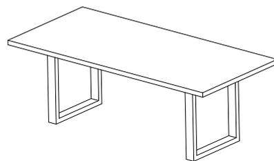
Stellen Sie vor dem Aufbau sicher, dass die Schraubenlänge zur Stärke der Tischplatte passt, um Schäden zu vermeiden! Andernfalls besteht die Gefahr, dass die Schrauben die Tischplatte durchbohren.
